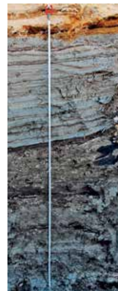
Profilen, hvor prøvesøjlen blev udtaget. Den sorte aftegning i skal- og gytjelaget i midten er en af træstammerne, der lå i laget.
