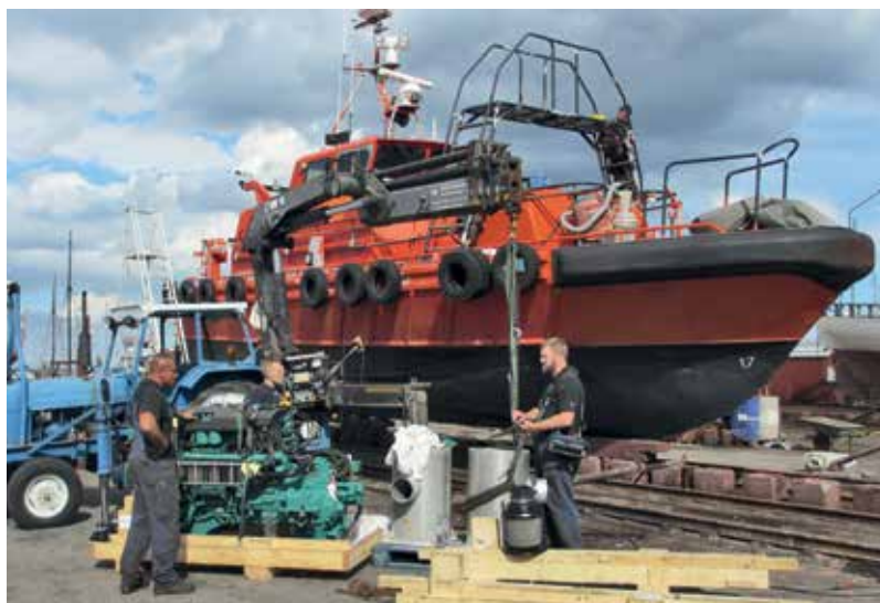
Lodsåden Venus fra det statsejede Dan-Pilot under renovering på beddingen i Gilleleje Havn. Smede fra Brd. Petersens Maskinfabrik forbereder installation af en ny dieselmotor.
